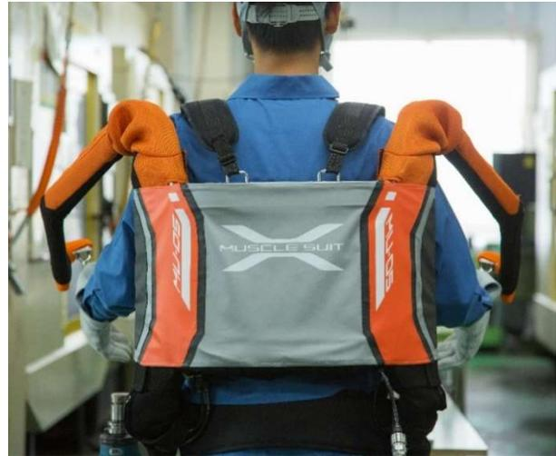
\*腰部を補助するために、下半身に対して上半身を回転させる（すなわち、上半身を伸展させる）力を補強します。この回転に伴って上肢のフレームも引き起こされ、腕を持ち上げるはたらきとして作用します。この回転力（トルク）の最大値は140Nmで、これは、腰部を中心とする回転軸から0.4mの地点で35.7kgfの補助力となります。
