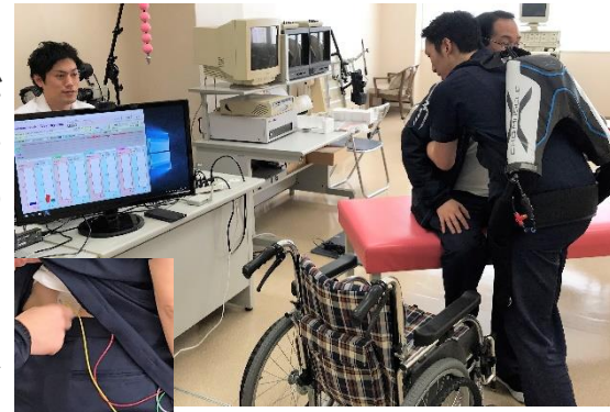
検証①：移乗介助時の筋電位の測定。 筋電位を測定するため肌パッドを貼り、マッスルスーツ®装着の上介助シーンを想定し実証
