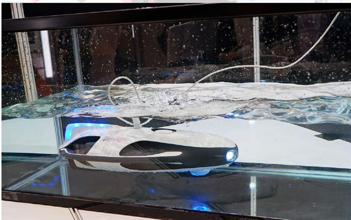
海底探査をする水中ドローン『PowerRay』。魚群探知機搭載、魚の状況や水温、地形などの監視が可能。
