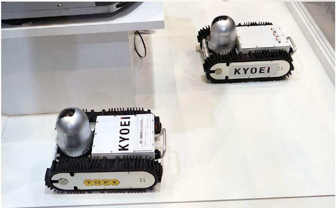
床下・設備点検ロボット『エニーライト』は、タブレット点検ツールで遠隔操作やレポート自動作成ができる。
