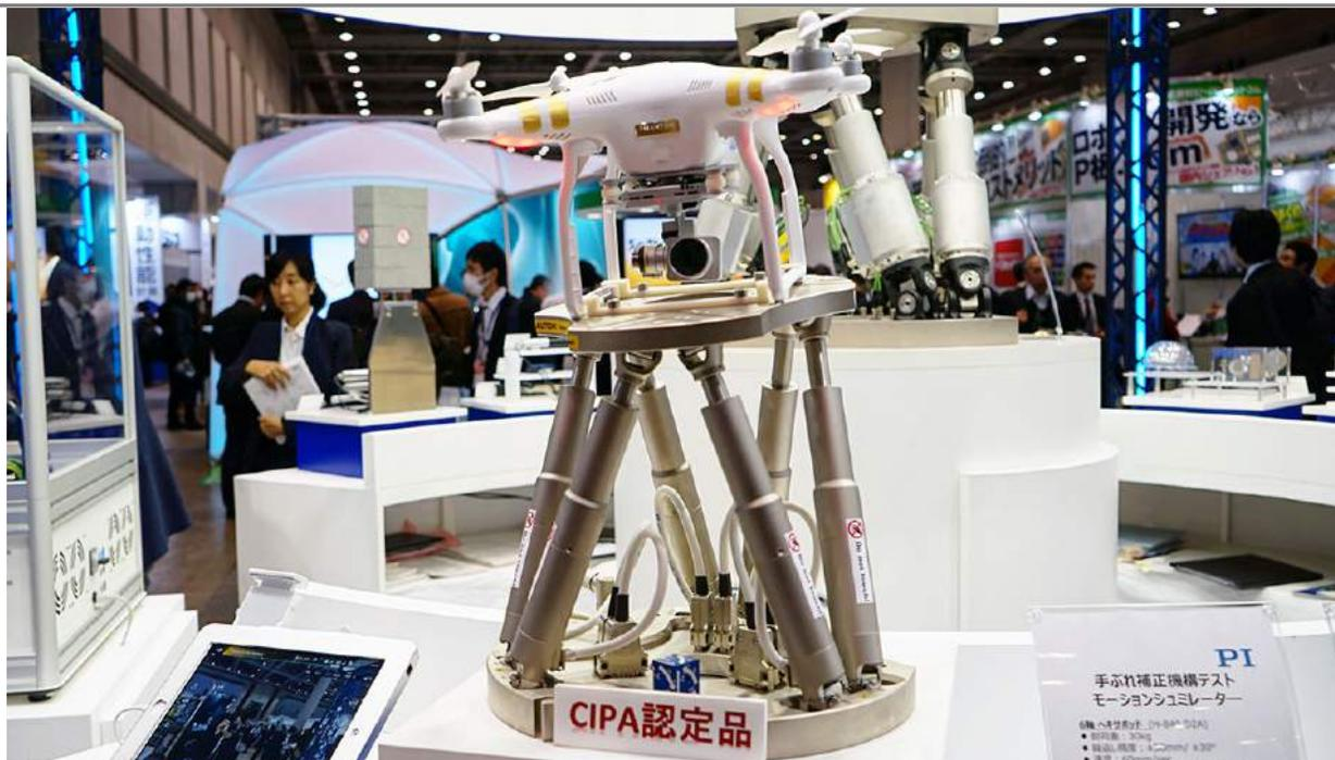
CIPA（カメラ映像機器工業会）認定の6軸ヘキサポッドによる、手ぶれ補正機構テストのモーションシュミレーター。ヘキサポッドによってあらゆる方向に傾くカメラの手ブレ防止機能を確認するデモを行った。
