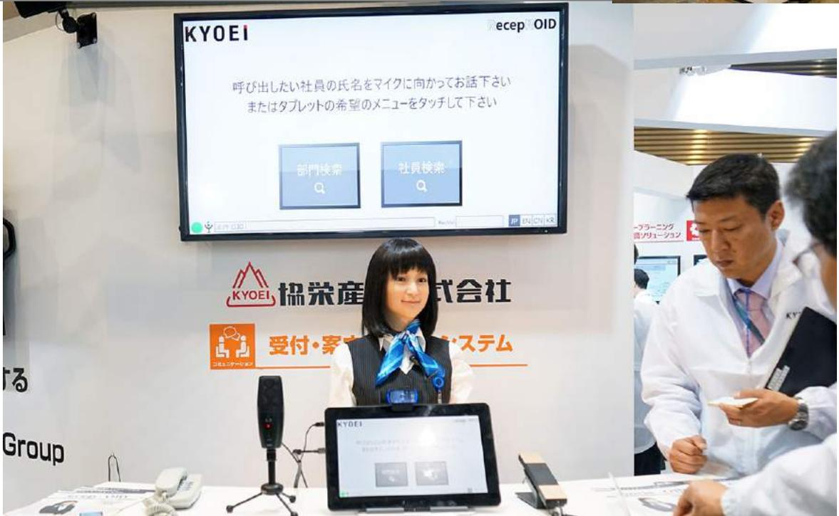
音声認識による対話式の案内が可能なお案内ロボットシステム『ConcieROID』。遠隔制御・監視など可能。
