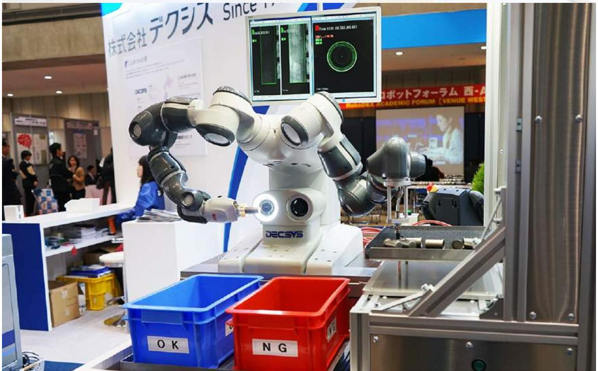
金属部品の外観検査デモ。検査用のソフトをティーチングペンダントに搭載しているという。
