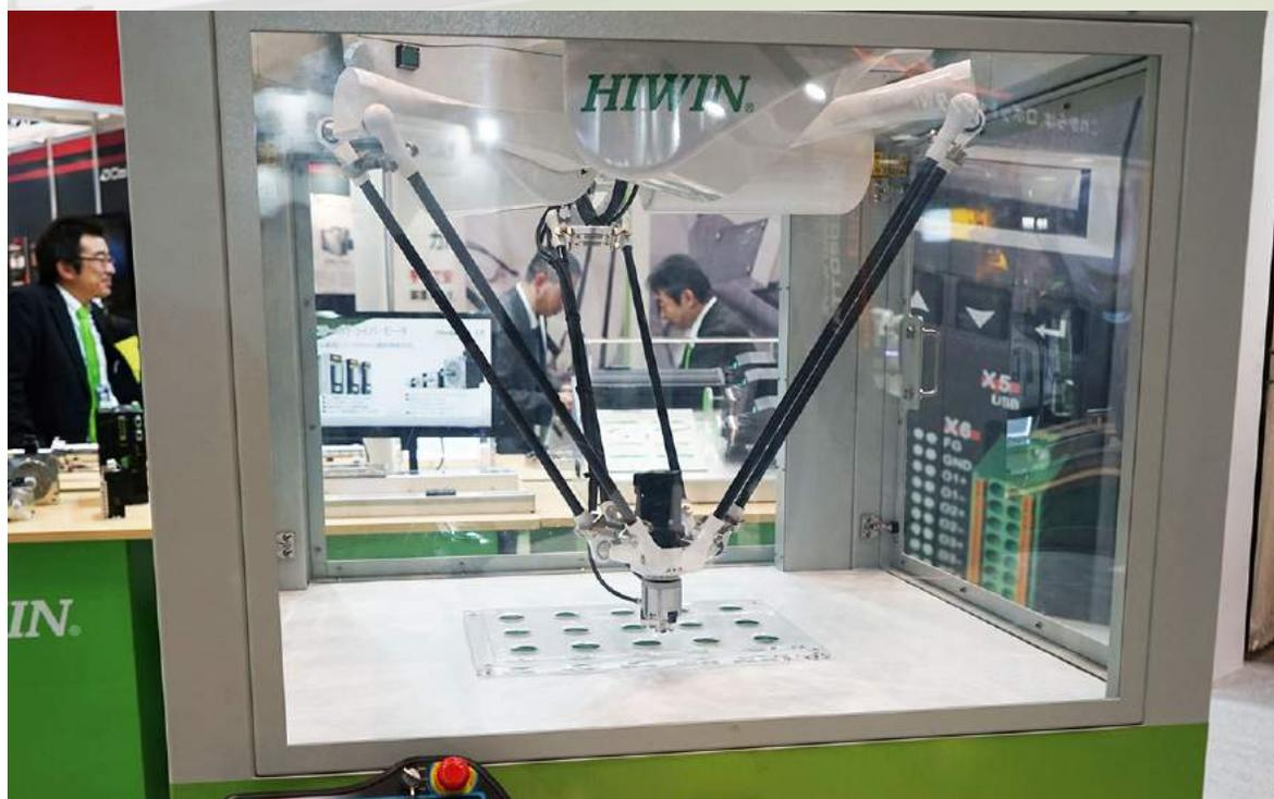
平行リンク機構を用いた4軸パラレルロボットによる搬送デモ。ハイスピードで安定した動きが特長。
