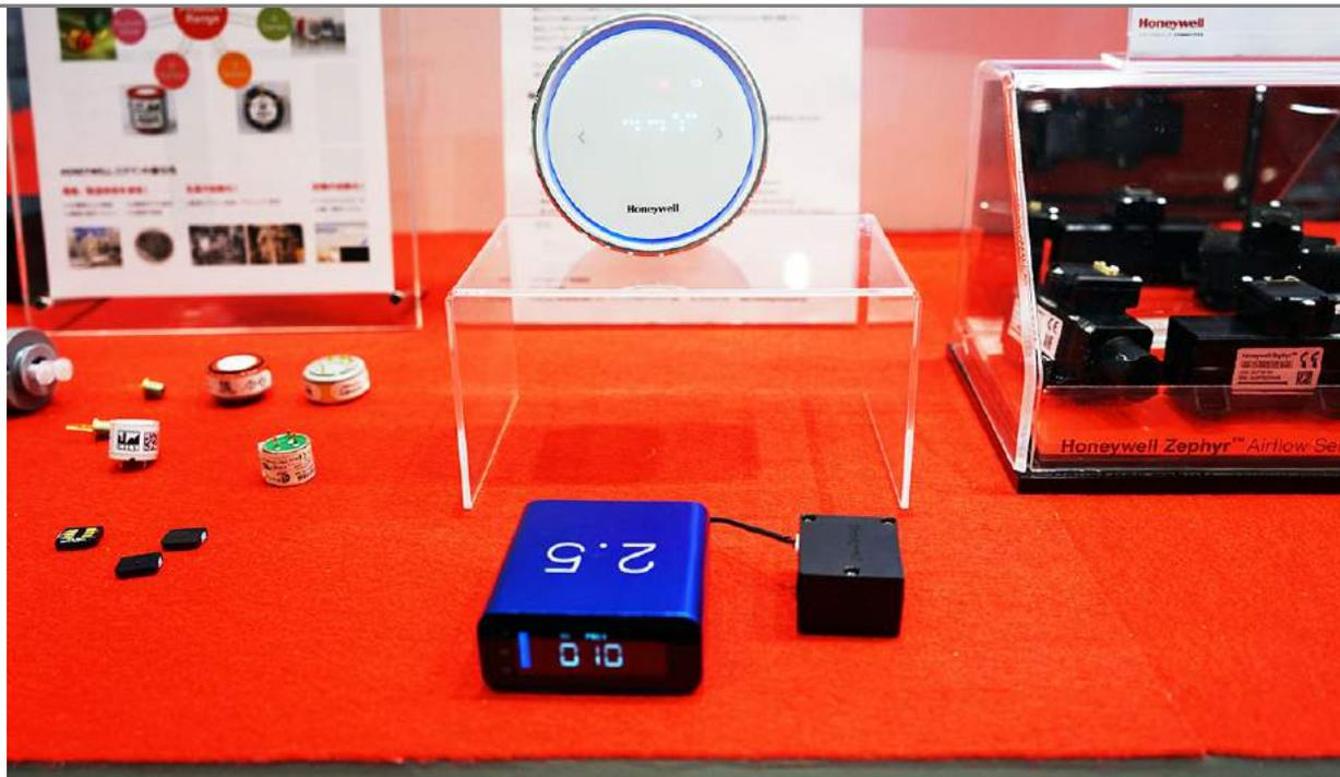
PM2.5濃度をリアルタイムに出力できる、レーザ散乱方式の検出器。20,000時間以上の連続使用が可能という。データはクラウドにあげてスマホなどで確認もできる。
