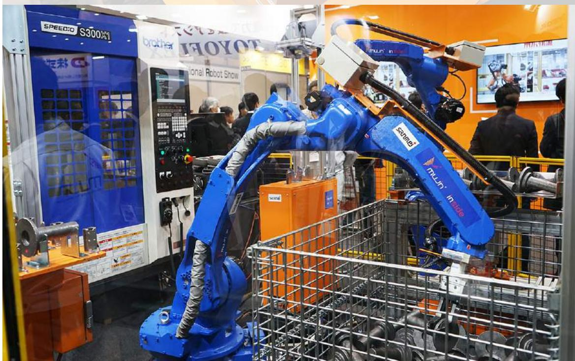
カメラの認識情報をコントローラへ伝達し、コントローラからロボットへ伝達。ロボットは自律的に作業を行う。
