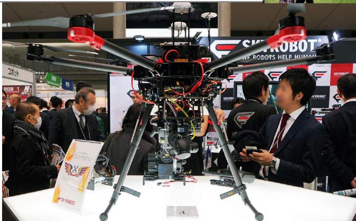
ガソリン燃料搭載のハイブリッドドローン。通常20～30分の飛行だが4時間を実現するという。
