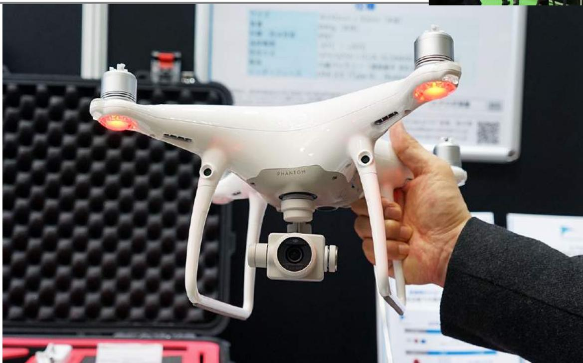
1インチのCMOSセンサーを搭載し、高精細な4K動画撮影、障害物を自動回避する『PHANTOM 4 PRO』。
