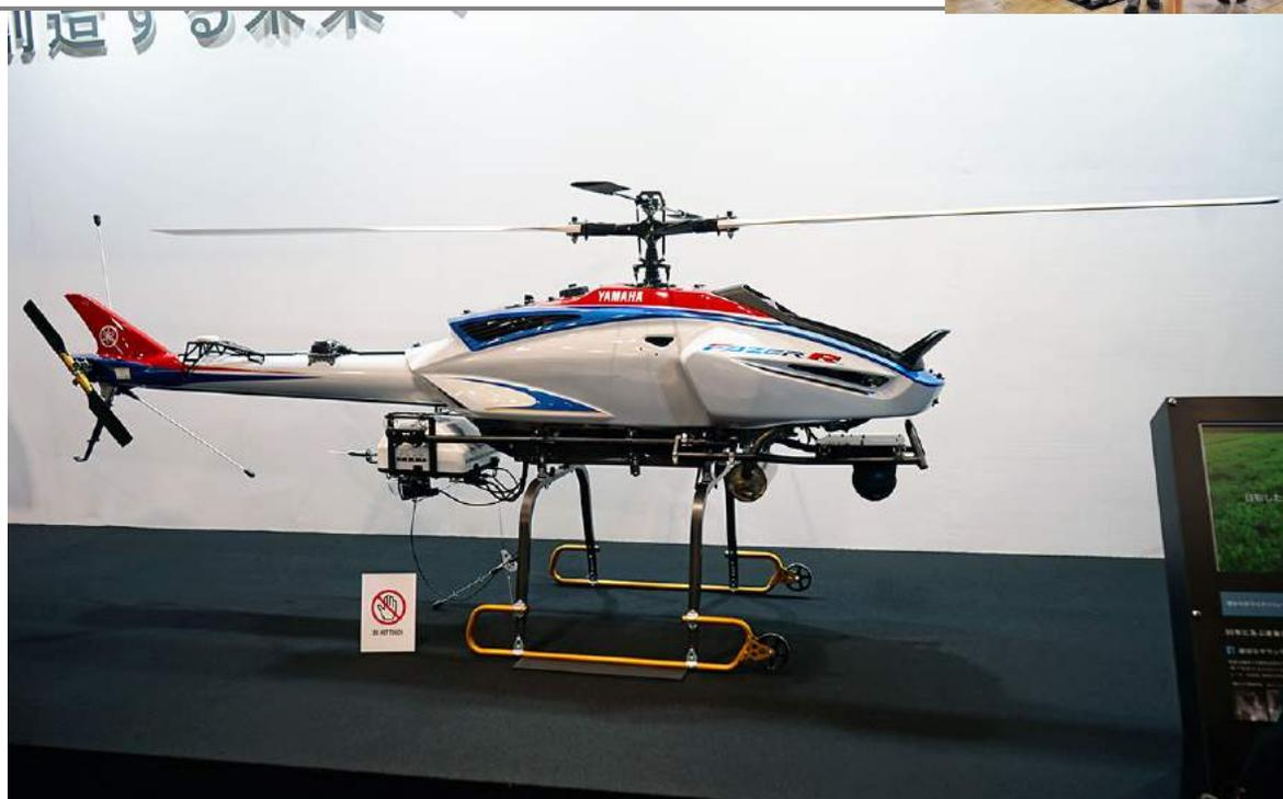
航続距離90km、高度2800mの標高への飛行が可能な産業用無人ヘリコプター。衛星通信を使用。
