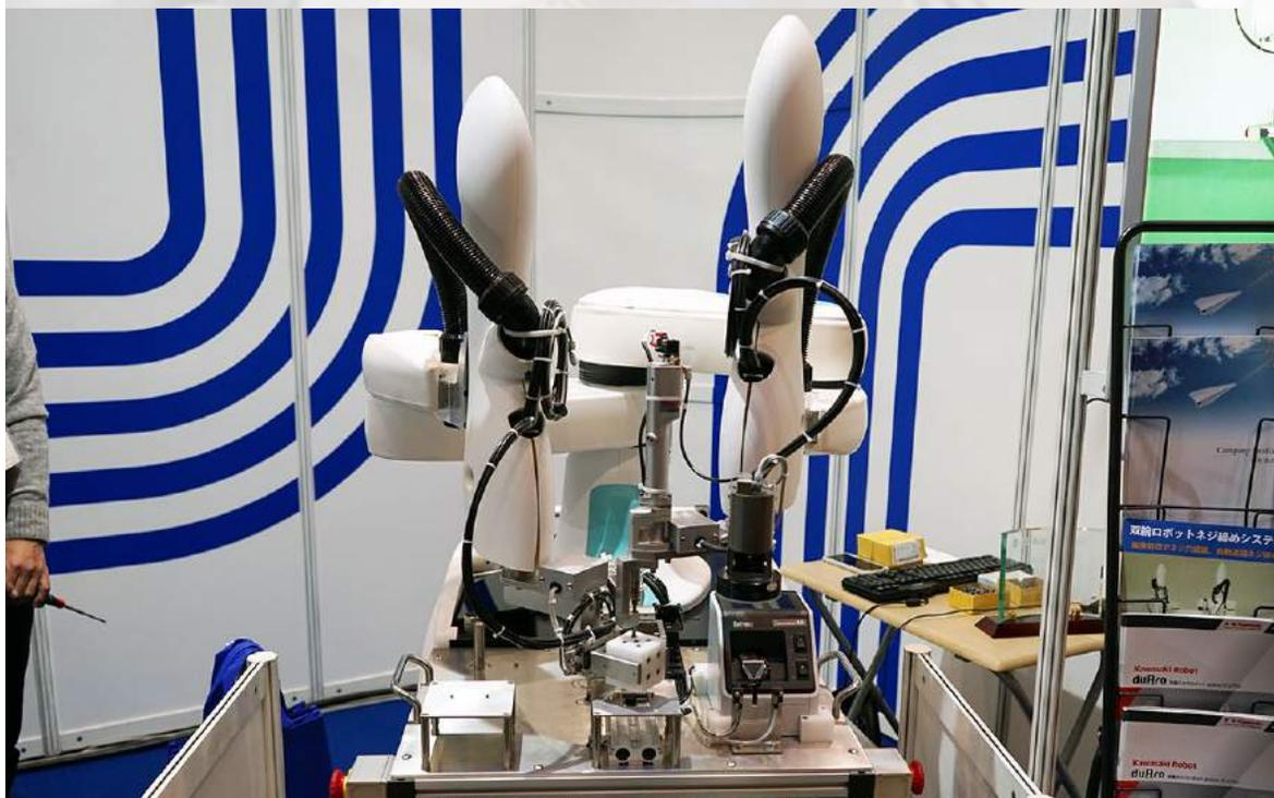
ネジ締め箇所を自動認識する、サンシステムの「双腕ロボットネジ締めシステム」。各種ロボットに適用可。
