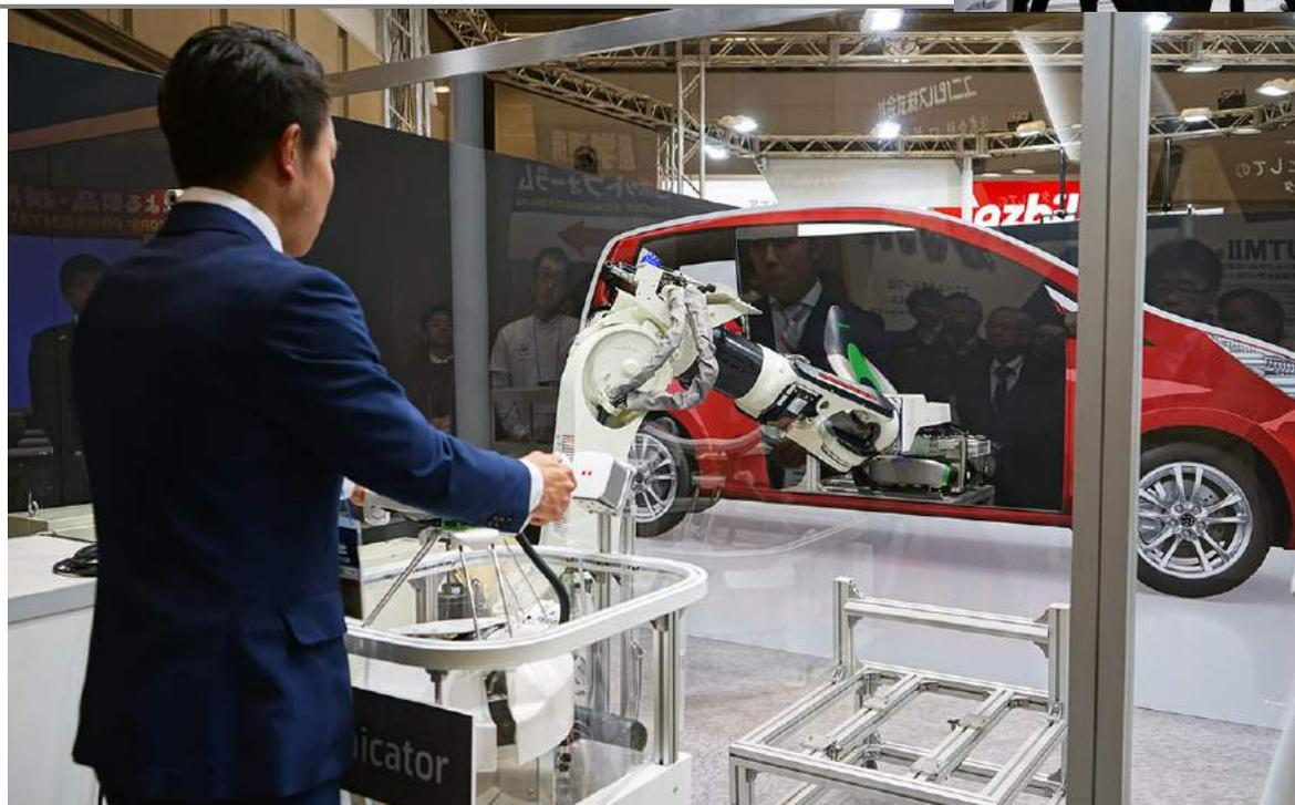
人によるロボットの遠隔操縦によりロボットが動きを学習し、自動化が可能になる『サクセサー』。
