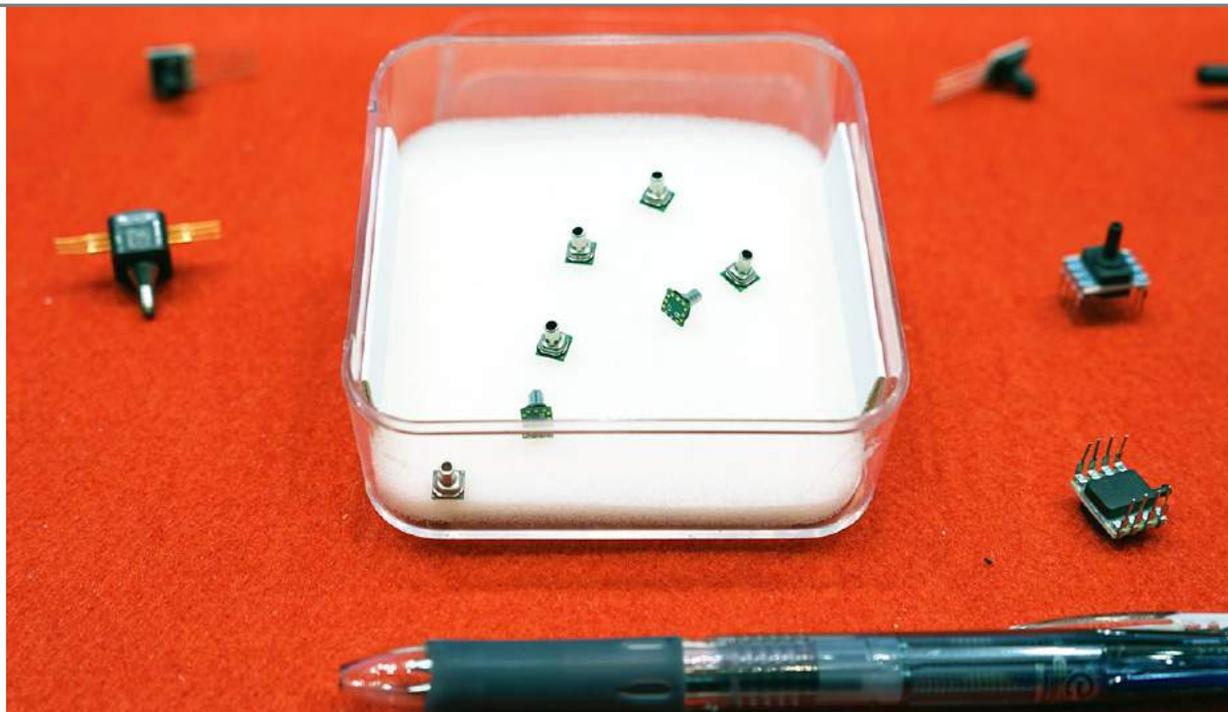
飲料水などの液体メディアにも対応可能な超小型圧力センサ。ロボットの指先に搭載し、どれくらいの圧を加えて作業を行うのかなどの確認に使用もできるという。
