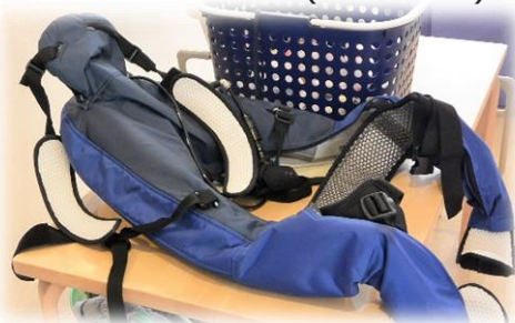
浴室前に設置されているマッスルスーツ®。脱着介助の際にすぐ使えるように常に業務の導線に置いている。
